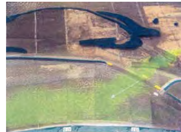
分流堰の諸元検討のための水理模型実験
