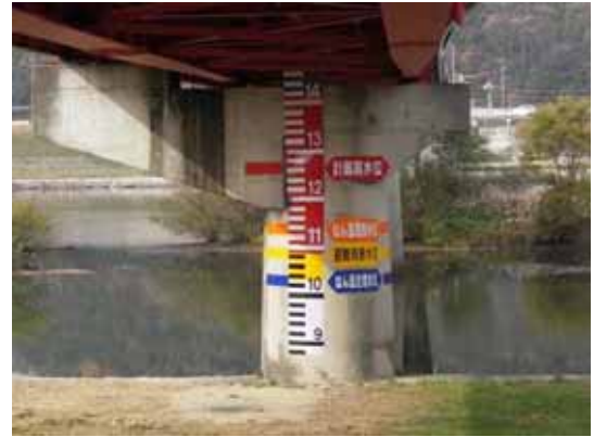
量水標（中原橋）
