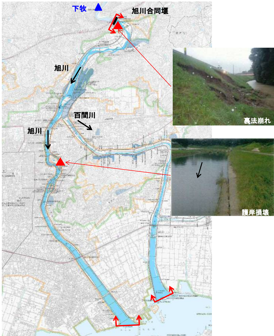
旭川国管理区間の被災状況及び復旧状況
