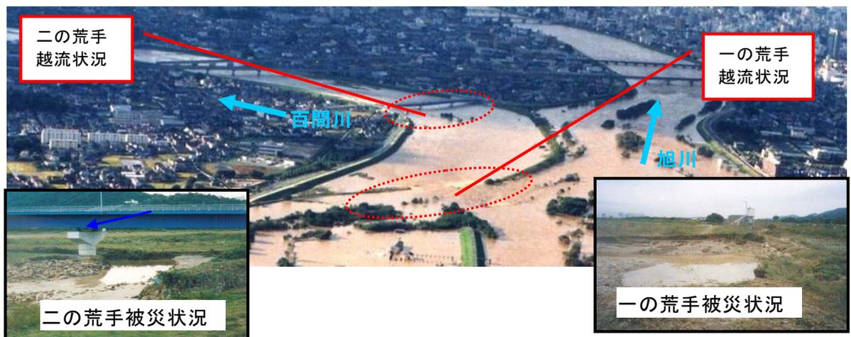
平成10年10月洪水による百間川への分流状況と一の荒手・二の荒手の被災状況
