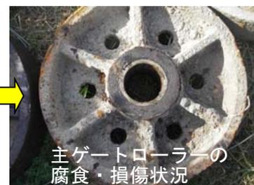
主ゲートローラーの腐食・損傷状況
