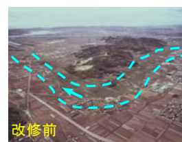
田園地帯を開削・築堤し放水路を築造 築堤は完成
