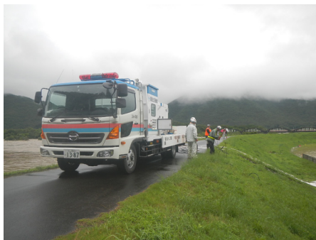
平成30年7月豪雨 排水ポンプ車出動状況
