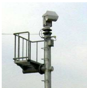
河川監視カメラ
