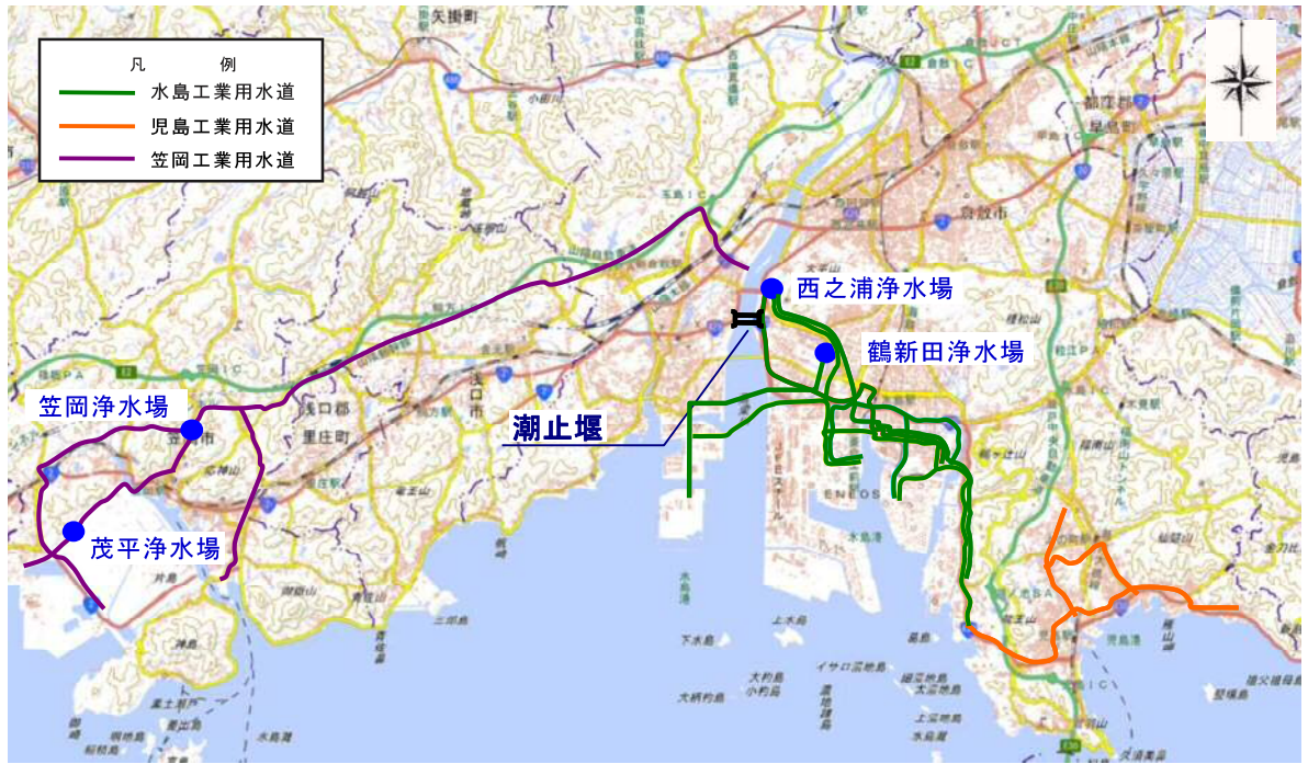
図1.4.4 工業用水道の幹線平面図
