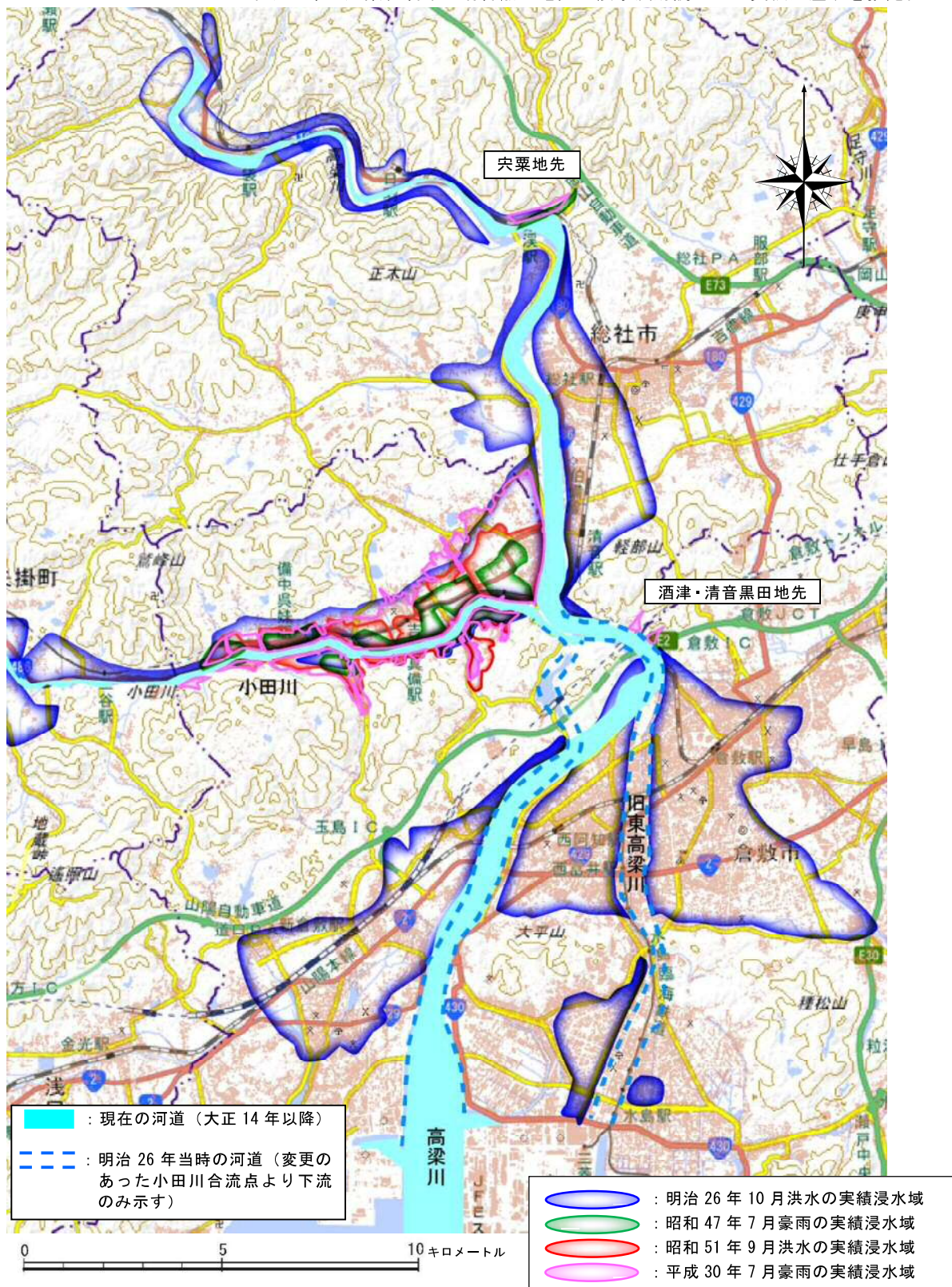
図 1.2.1 主要な洪水における実績浸水区域
