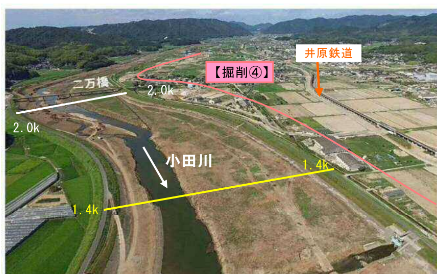
図5.1.25 小田川 河道掘削の位置図(1.0k～2.0k付近)
