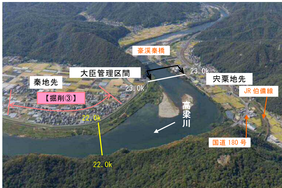
図5.1.23 高梁川 河道掘削の位置図(22.0k～23.0k付近)
