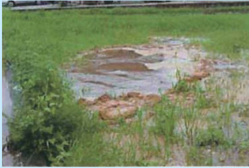
吹き上げ(居住地側の地面から水が吹き出る)の状況
