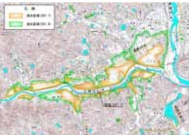
主要洪水の浸水区域図 (S47.7、S51.9)
