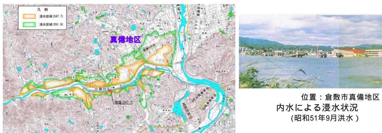
図3.1.4 主要洪水の浸水区域図(倉敷市真備地区)
