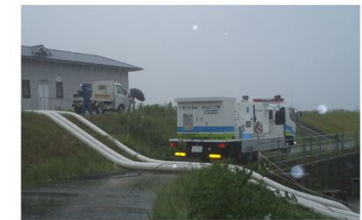
写真 2.1.6 排水ポンプ車出動状況 (平成 23 年 9 月台風 12 号：西大寺新地先)
