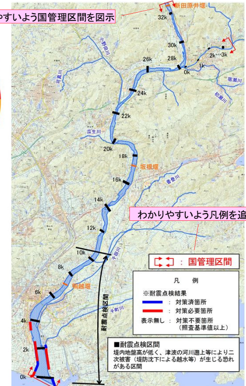
図2.1.12 堤防耐震点検の実施状況(平成29年3月現在)
