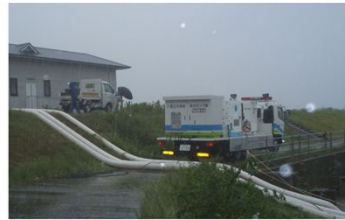
写真 2.1.6 排水ポンプ車出動状況 (平成 23 年 9 月台風 12 号：西大寺新地先)
