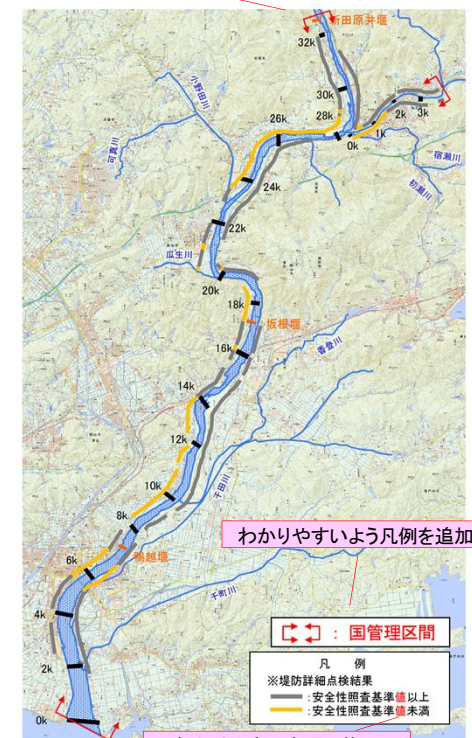
図 2.1.8 堤防詳細点検の実施状況(平成29年3月現在)
