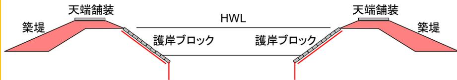
【参考】国と倉敷市が連携した堤防強化（堤防断面の拡大）の方法
