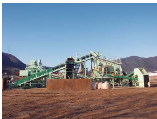
盛土材改良プラント稼働状況
