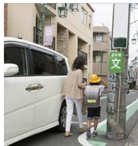
＜歩行の支障となる電柱の事例＞
