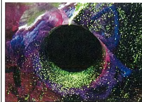
MT状況 (孔壁の亀裂状況:6時方向)
