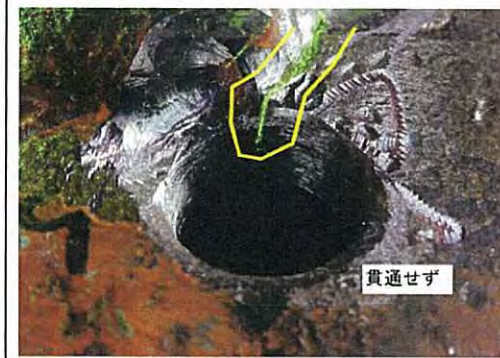
MT状況 (孔壁の亀裂状況:6時方向)
