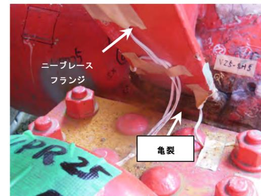
写真-3.1 VPR25 亀裂状況
