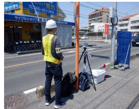
■ AIカメラ現地設置状況
