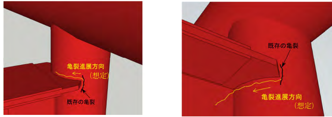
(a) 上フランジ上面 (b) 上フランジ下面 図-2.3 横桁上フランジ接合部で想定される亀裂の進展
