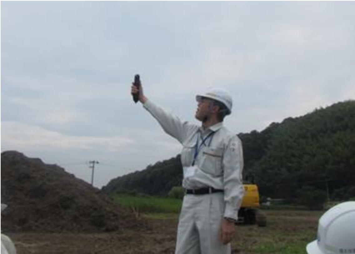
このように風速計で風を測ります。ちなみに、風速が **5m/s** を超えてしまった場合は飛行中止です。
