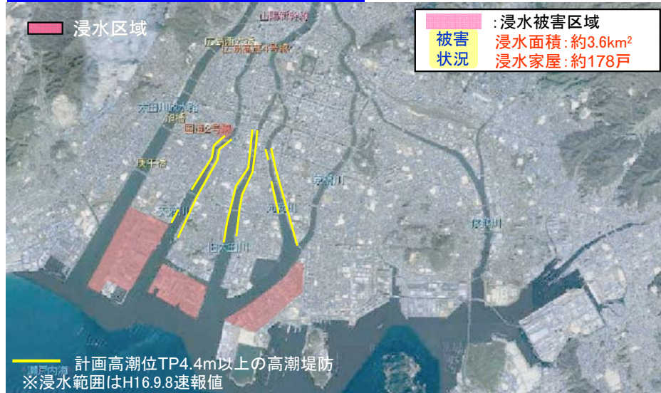
平成16年18号台風浸水被害状況
