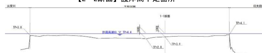
【2-2断面】護岸高不足箇所
