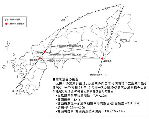
図 2.2.10 高潮計画の概要及び過去の台風の経路
