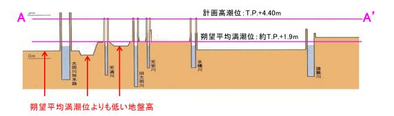
図 3.1.35 下流デルタ域の横断図
