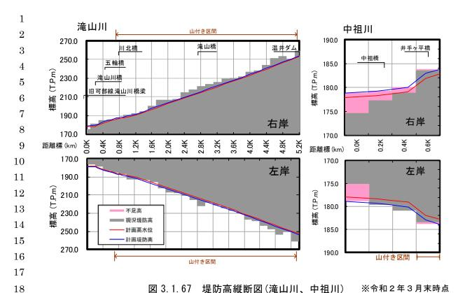
図 3.1.67 堤防高縱断図(滝山川、中祖川) ※令和2年3月末時点
