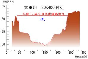
図3.1.2 平成17年9月洪水の痕跡水位
