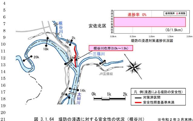
図 3.1.64 堤防の浸透に対する安全性の状況(根谷川) ※令和2年3月末時点 ※注:色のない箇所は、居住地側が計画高水位より高い場合や山などで、調査の必要がない区間
