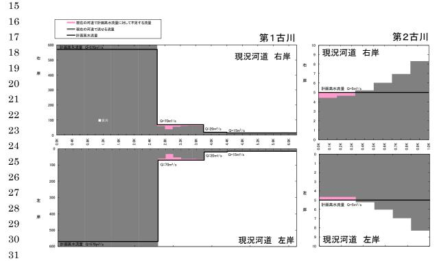
図 3.1.44 現況流下能力図(第1古川、第2古川) ※令和2年3月末時点
