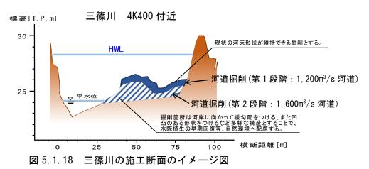
注 1) 広島県管理区間の災害復旧等による流下能力向上を踏まえ、上下流の治水バランスを考慮し、段階的な整備として、1,200m³/s を安全に流下させるための堤防整備及び河道掘削を実施します。その後、本支川の治水バランス及び環境への影響を考慮しつつ、1,600m³/s を安全に流下させるための河道掘削に着手します。
