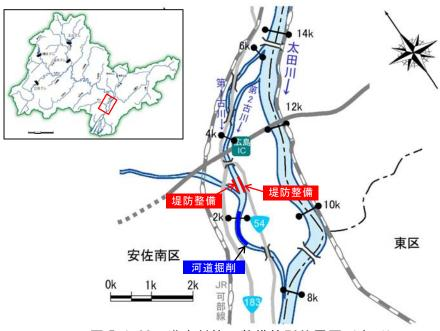
図 5.1.28 洪水対策の整備箇所位置図(古川)
