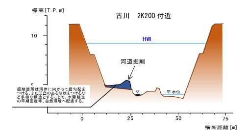
図 5.1.29 古川の施工断面のイメージ図
