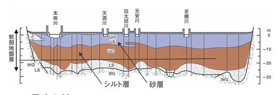
図 3.1.36 下流デルタ域の地質断面図 (A-A' 断面付近)
