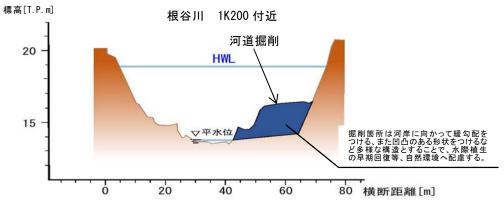
図 5.1.24 根谷川の施工断面のイメージ図
