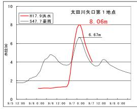
図 3.1.9 飯室水位・流量観測所及び矢口第1水位・流量観測所の水位
