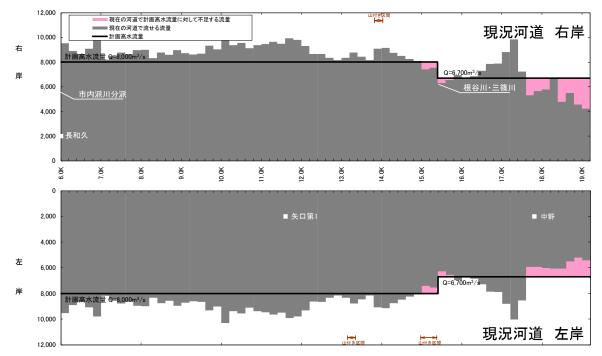
図 3.1.41 現況流下能力図(下流部)
