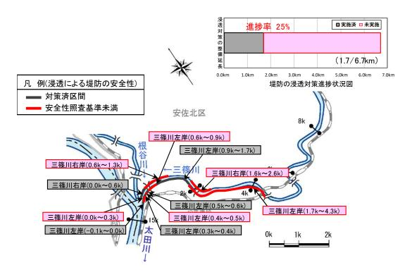
図 3.1.59 堤防の浸透に対する安全性の状況(三篠川)※令和2年3月末時点 ※注:色のない箇所は、居住地側が計画高水位より高い場合や山などで、調査の必要がない区間
