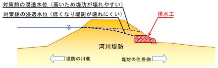
図 5.1.11 堤防の浸透対策を実施する箇所の横断イメージ図
