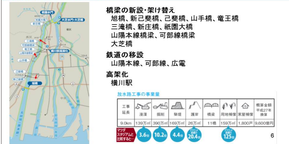
図—5 放水路工事に伴って行われた工事(1)
