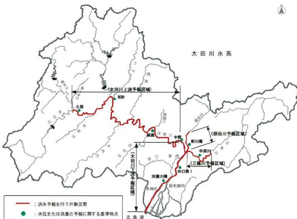
太田川 洪水予報を行う対象区間及び水位または流量の予報に関する基準地点
