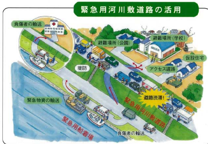
図-9.4.2 緊急用河川敷道路の活用
