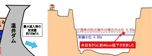
図 3.1.71 平成 30 年 7 月豪雨における温井ダムの洪水調節効果
