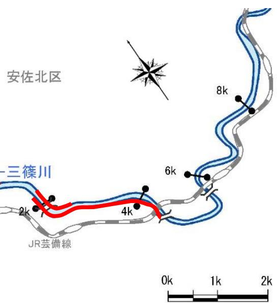
図 5.1.22 堤防の浸透対策の実施箇所位置図（三篠川）
