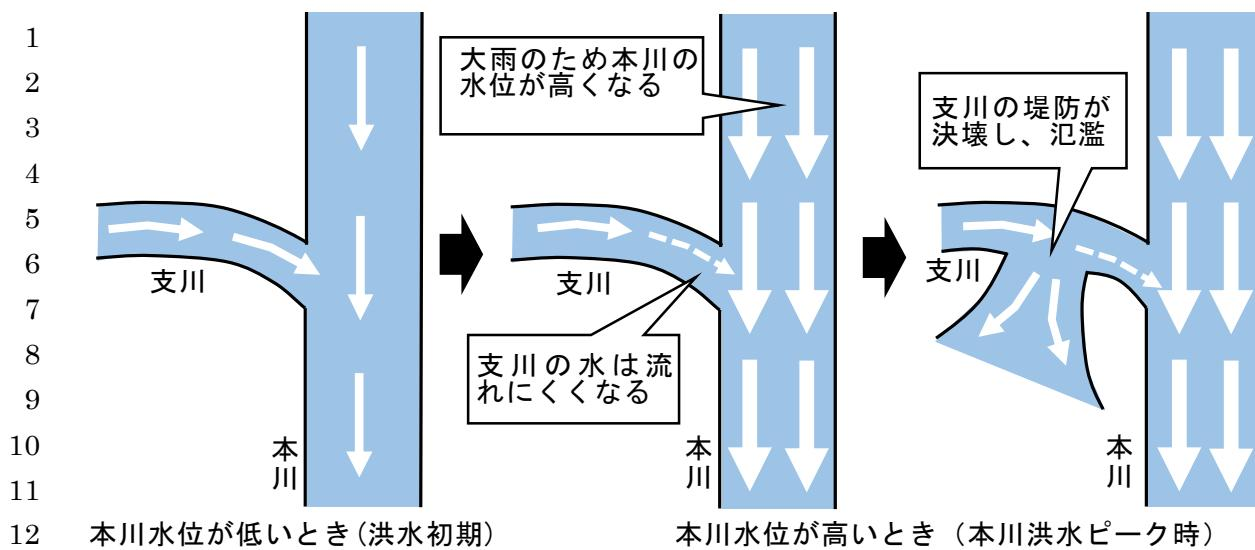
図 3.1.6 バックウォーター現象による氾濫のメカニズム
