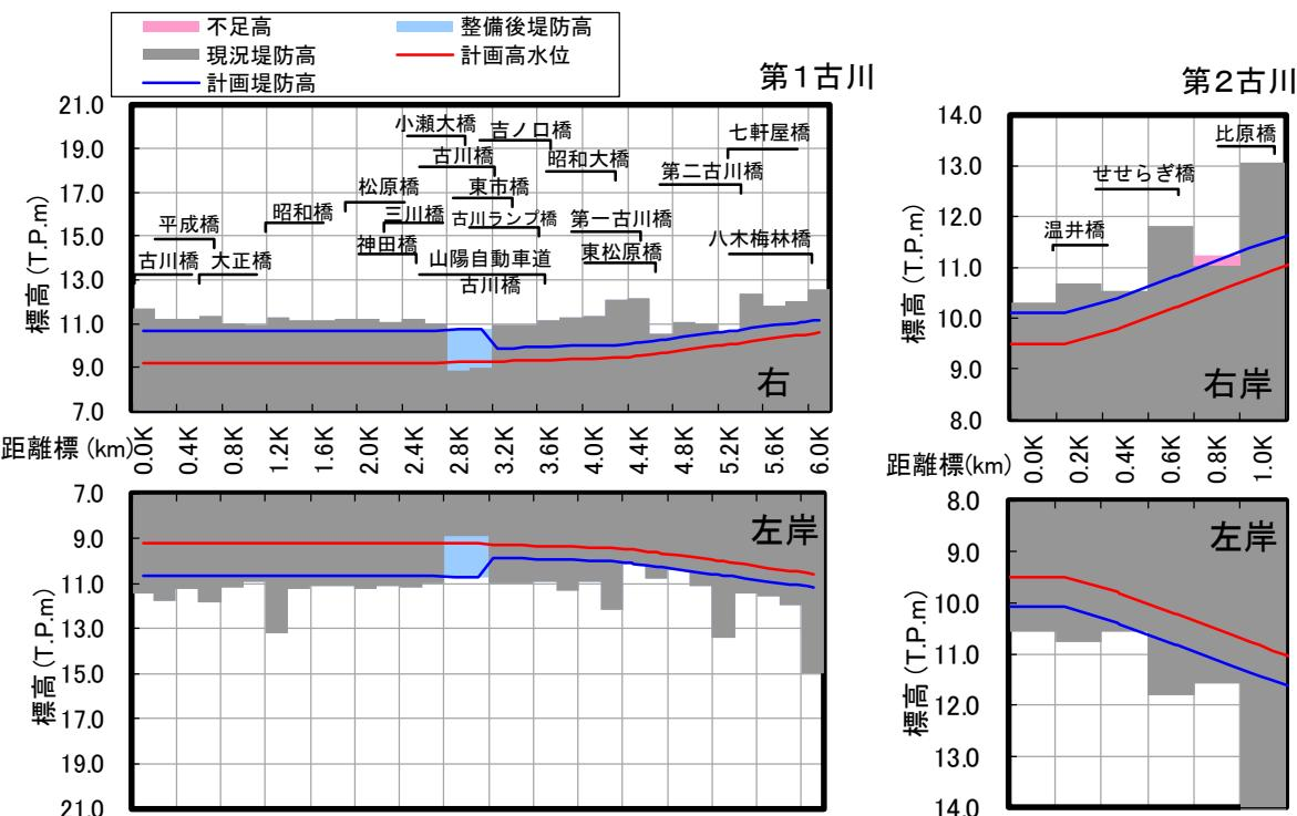
図 5.1.32 堤防高縦断図（第1古川、第2古川）
