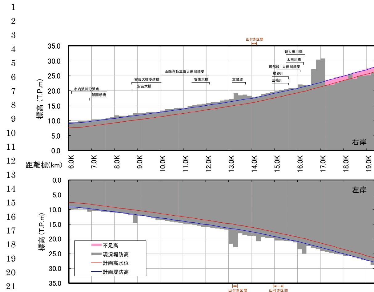
図 3.1.44 堤防高縦断図(下流部) ※令和2年3月末時点
