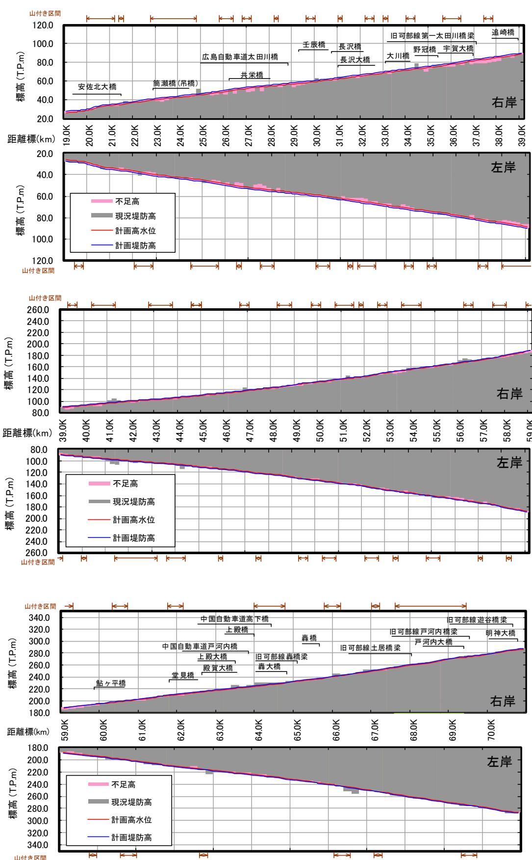
図 3.1.54 堤防高縦断図(中流部)
