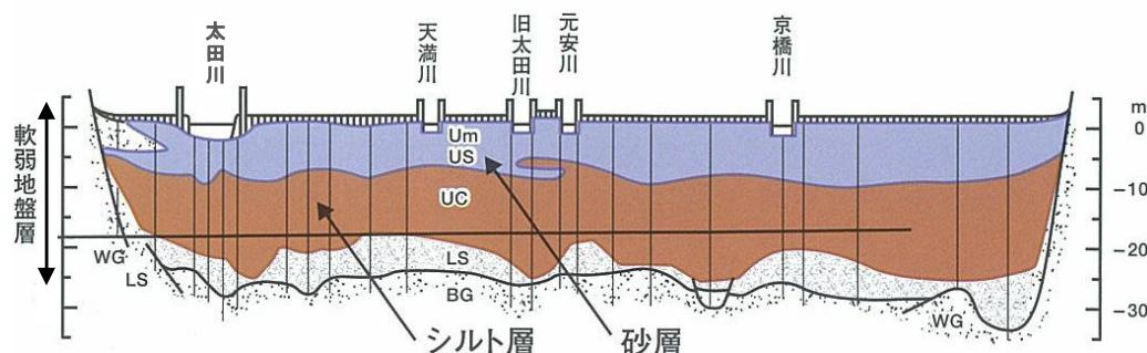
図 3.1.38 下流デルタ域の地質断面図 (A-A' 断面付近)
