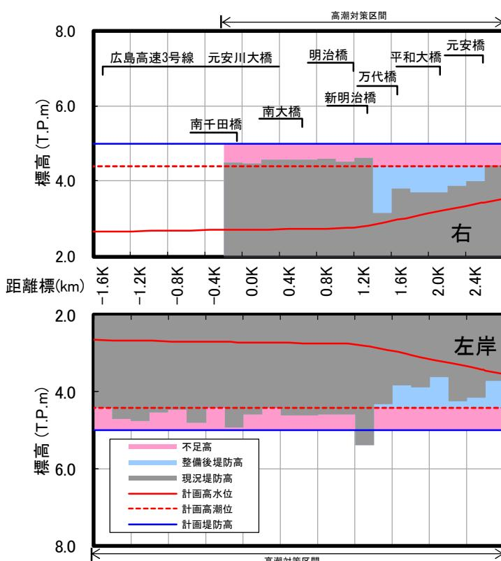
図 5.1.4(4) 堤防高縦断図（元安川）
