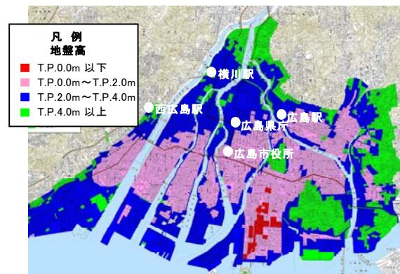
図 3.1.29 下流デルタ域の地盤高図
