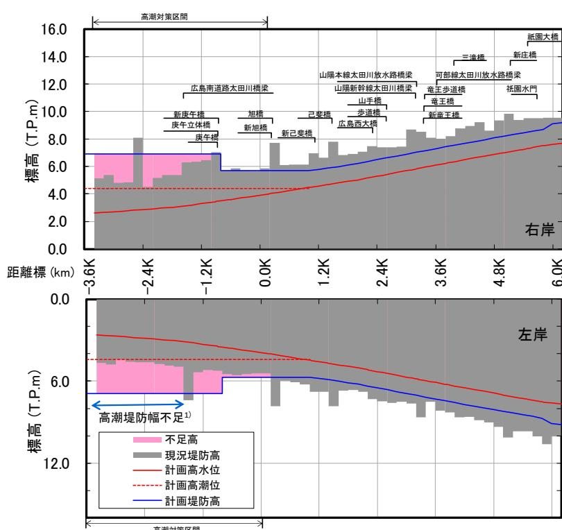
図 3.1.34(1) 堤防高縦断図(太田川)<sup>1)</sup> ※令和2年3月末時点
