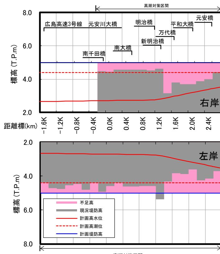
図 3.1.34(4) 堤防高縦断図(元安川) ※令和2年3月末時点
