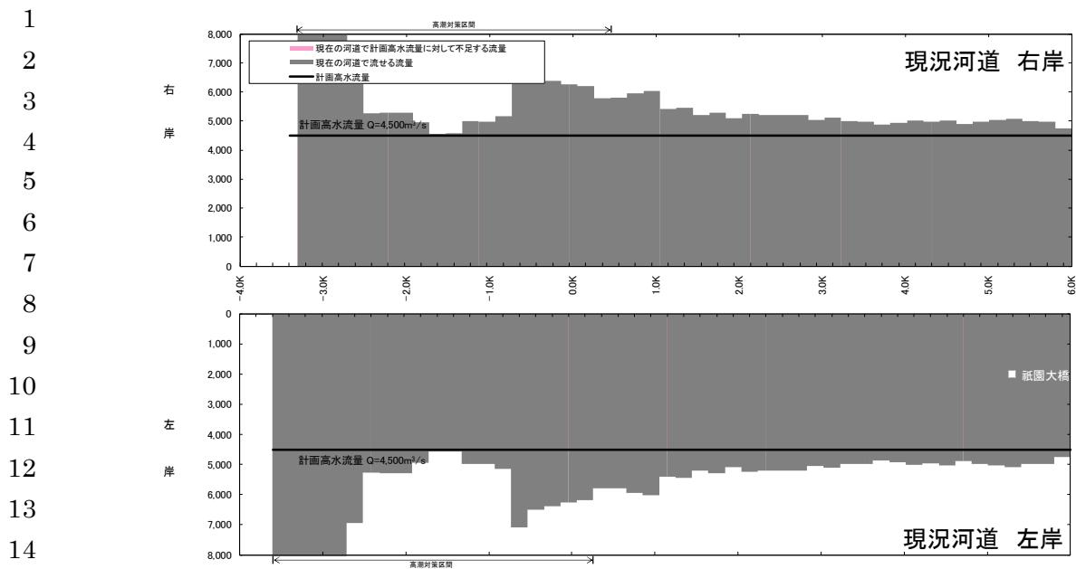
図 3.1.32 現況流下能力図(太田川) ※令和2年3月末時点
