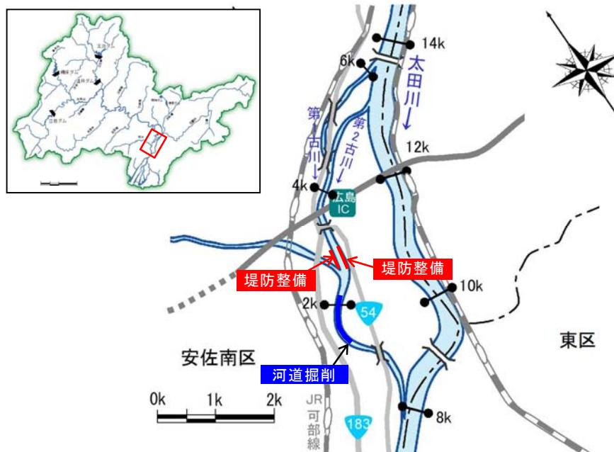
32 図 5.1.28 洪水対策の整備箇所位置図（古川）
