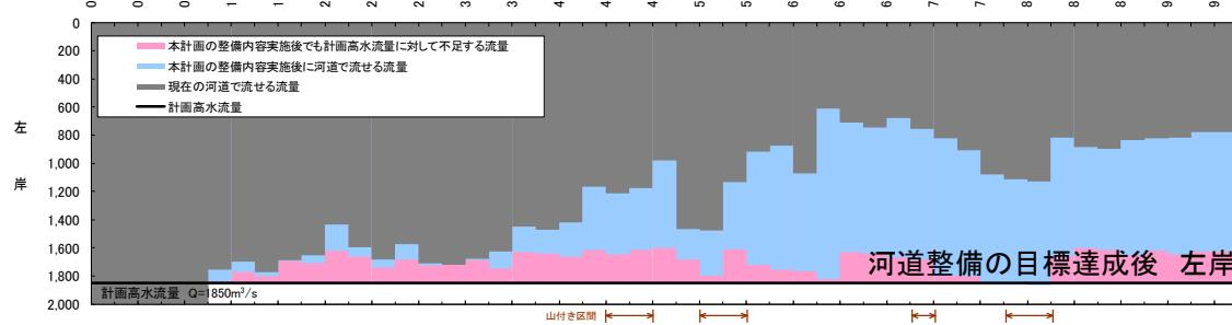
図 5.1.20 流下能力図（三篠川）
