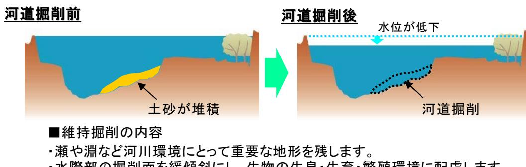
31     図 5.4.4 河道掘削による水位低下のイメージ
