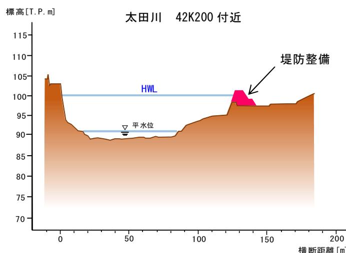
図 5.1.13 中流部の施工断面のイメージ図
