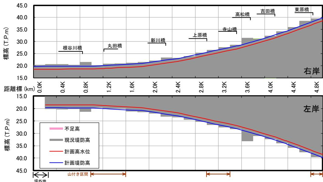
図 3.1.64 堤防高縦断図(根谷川)
