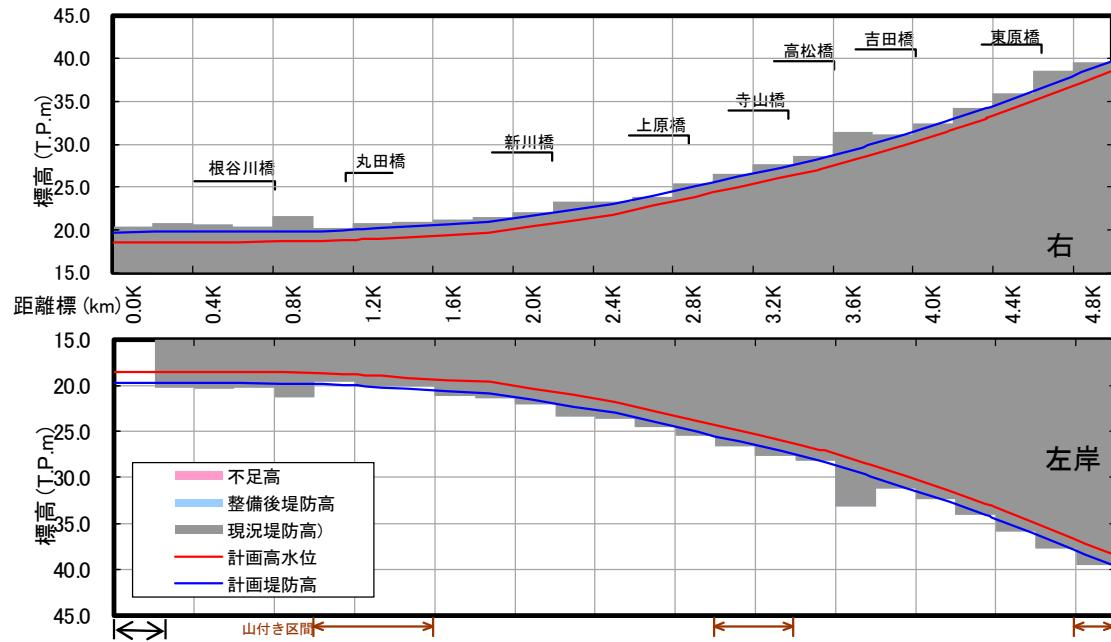
図 5.1.26 堤防高縦断図（根谷川）
