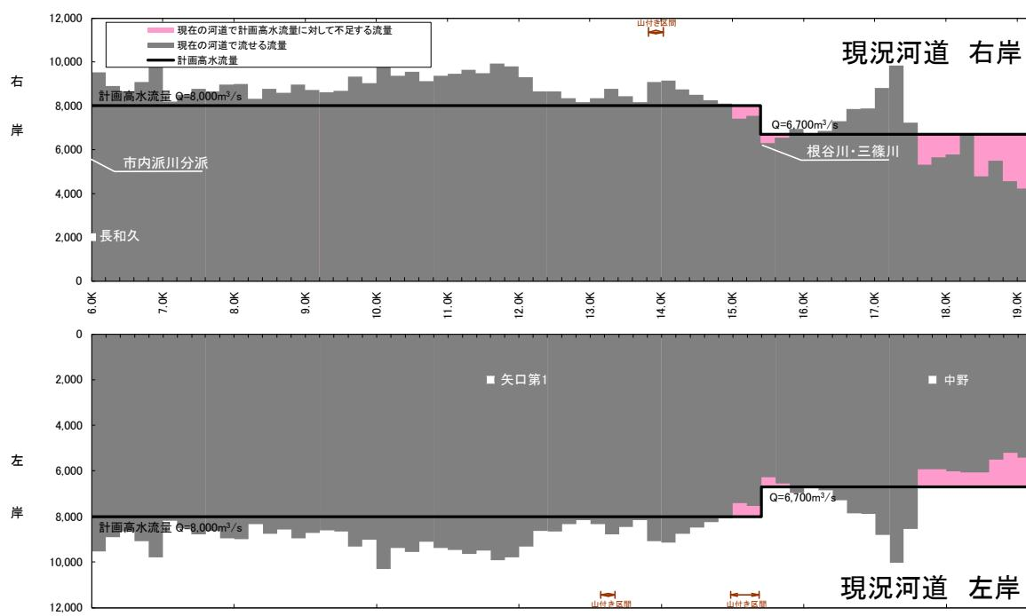
図 3.1.43 現況流下能力図(下流部)
