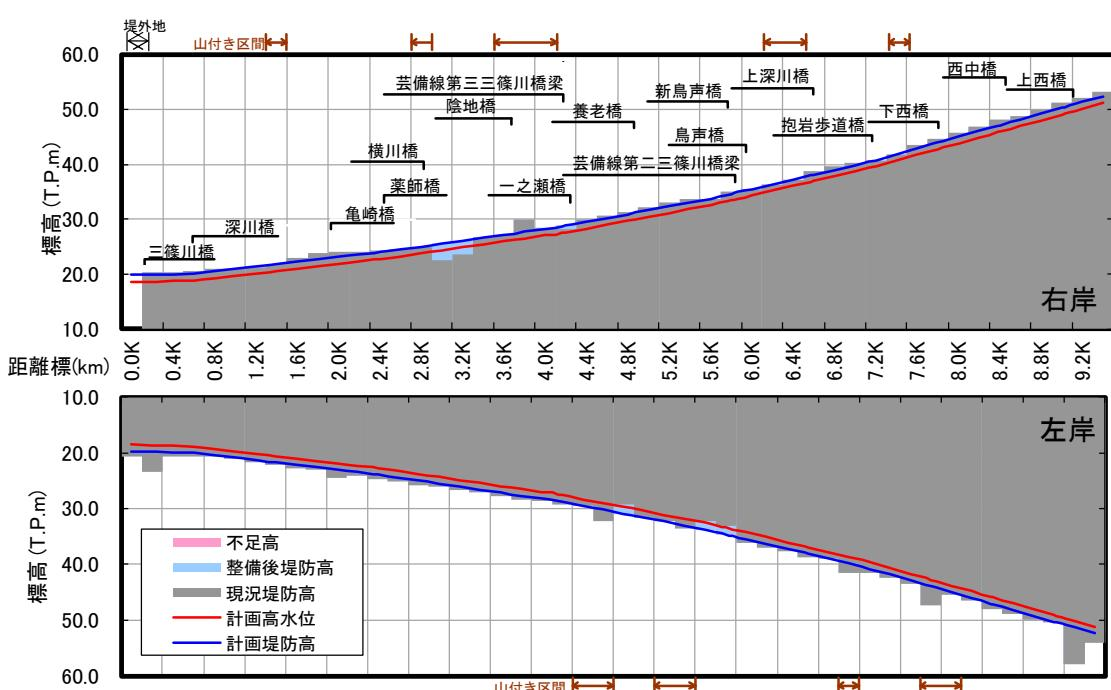
図 5.1.21 堤防高縦断図（三篠川）
