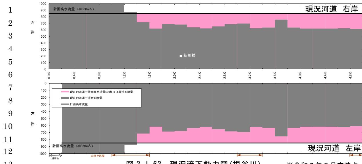
図 3.1.63 現況流下能力図(根谷川)
