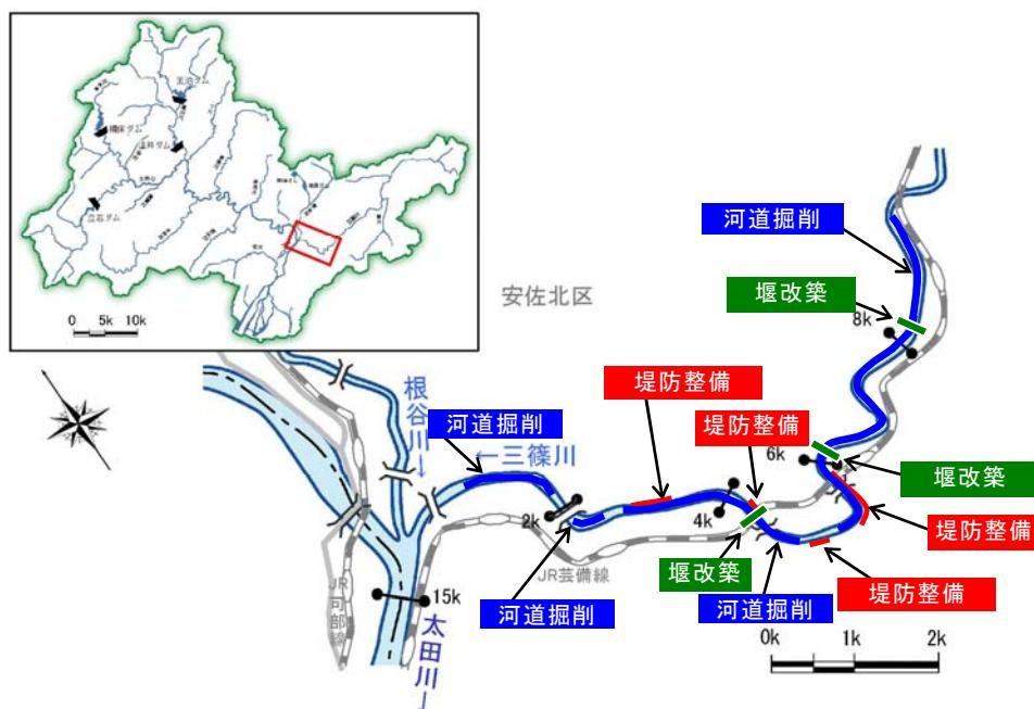
図 5.1.19 洪水対策の整備箇所位置図（三篠川）
