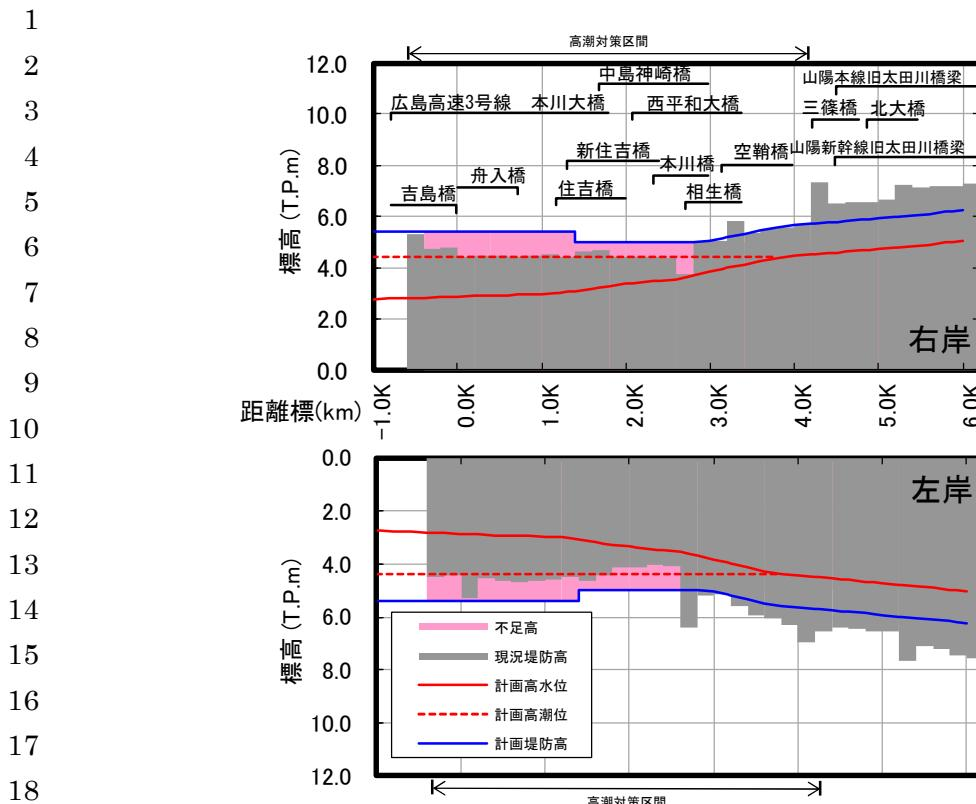
図 3.1.34(3) 堤防高縦断図(旧太田川) ※令和2年3月末時点
