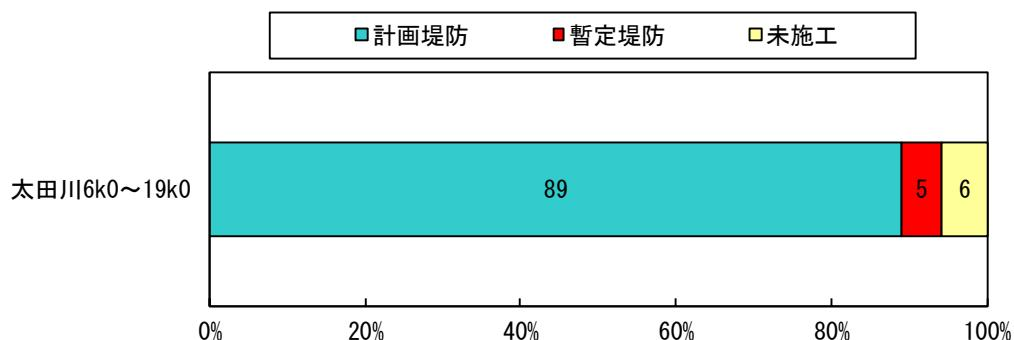
図 3.1.45 堤防整備率(下流部) ※令和2年3月末時点
