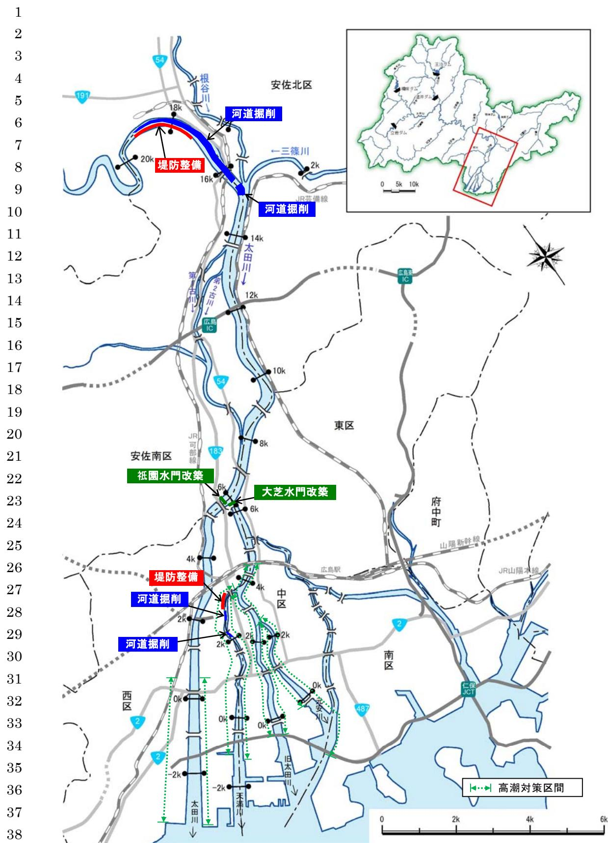
図 5.1.2 洪水対策の整備箇所位置図（下流部・下流デルタ域）
