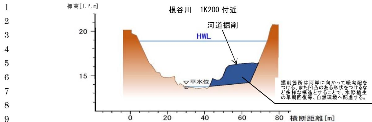
図 5.1.24 根谷川の施工断面のイメージ図
