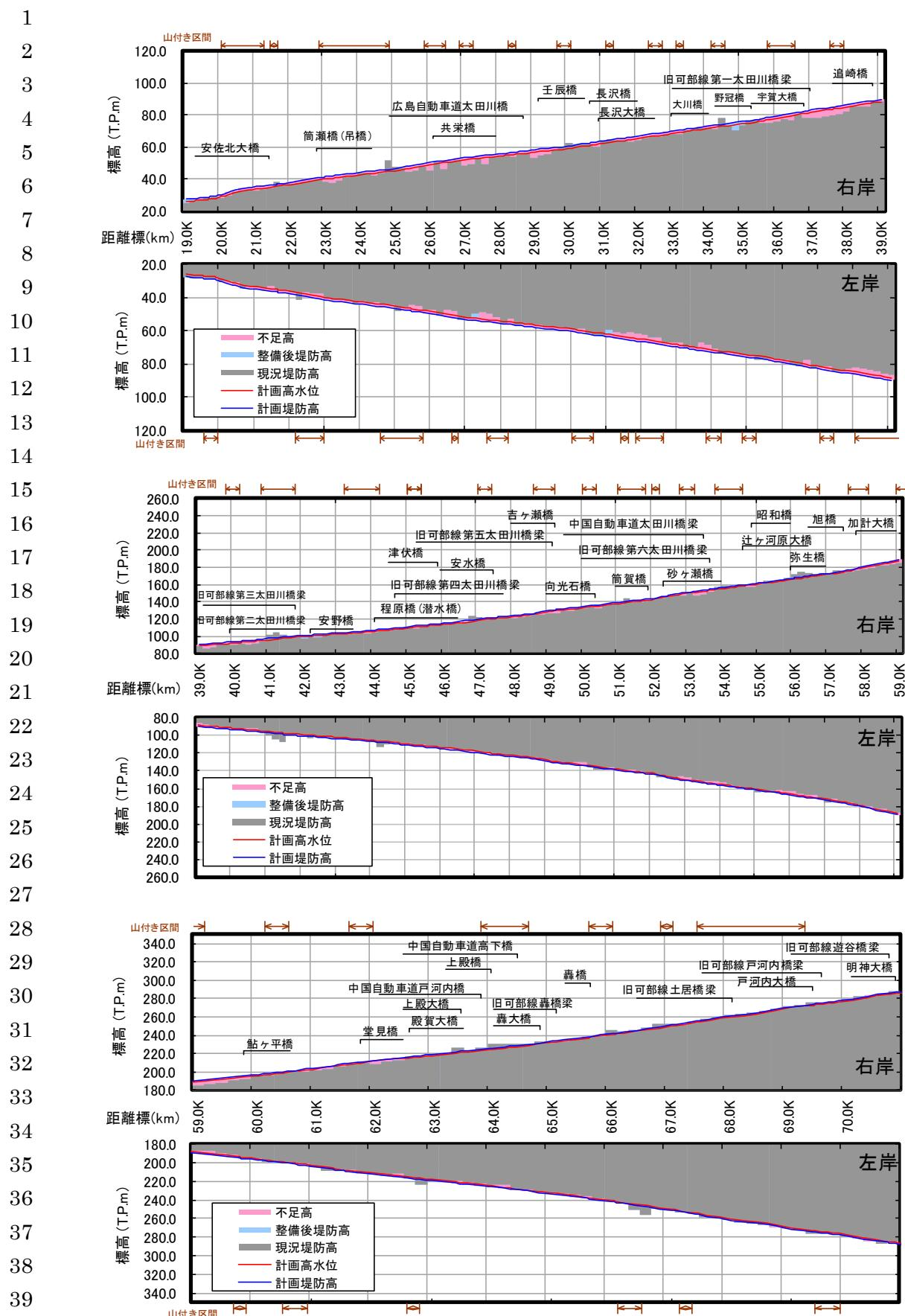
図 5.1.17 堤防高縦断図(中流部)
