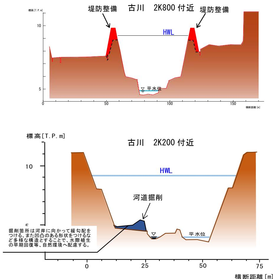
図 5.1.29 古川の施工断面のイメージ図
