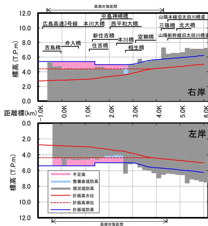
図 5.1.4(3) 堤防高縦断図（旧太田川）
