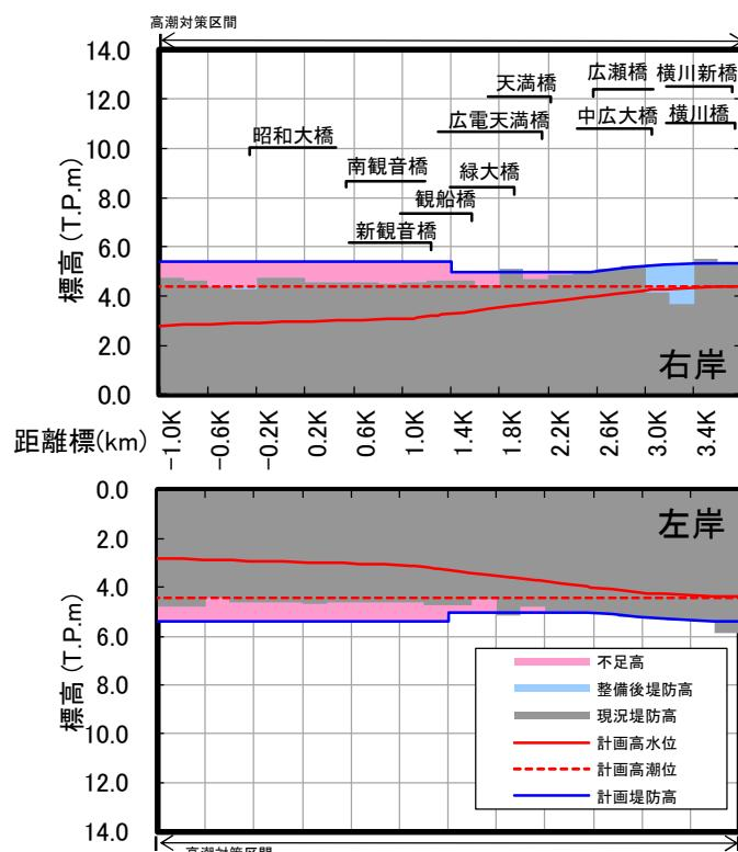
図 5.1.4(2) 堤防高縦断図（天満川）
