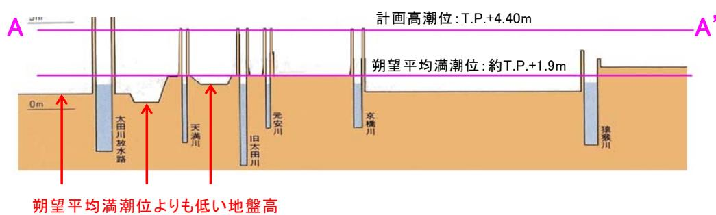
図 3.1.37 下流デルタ域の横断図
