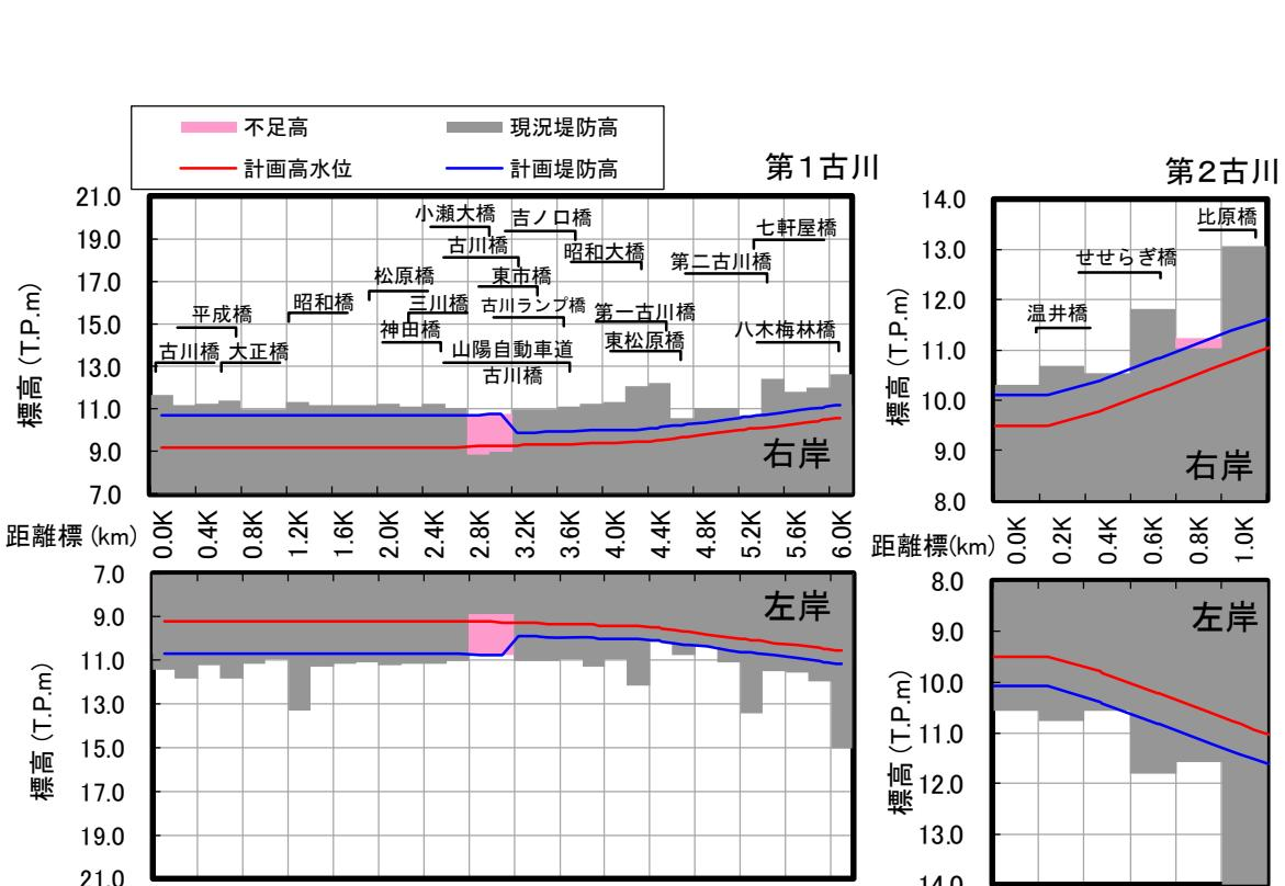
図 3.1.47 堤防高縦断図(第1古川、第2古川) ※令和2年3月末時点
