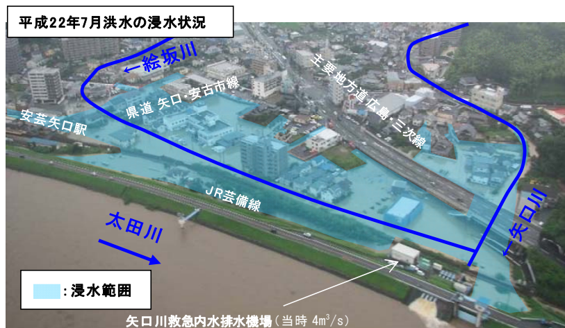
図 2.2.9 平成 22 年 7 月洪水による浸水状況
