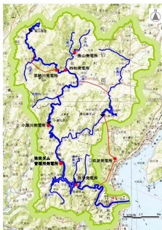
図-5.1.3 小瀬川水系発電所模式図
