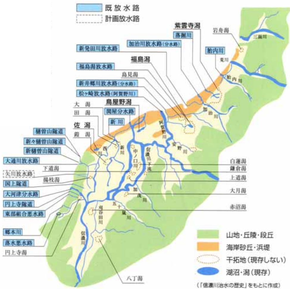
図 4-45 新潟平野の放水路の整備状況
