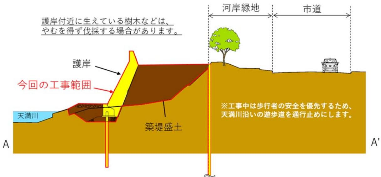
計画横断イメージ図\*(上記平面図のA-A'断面)
