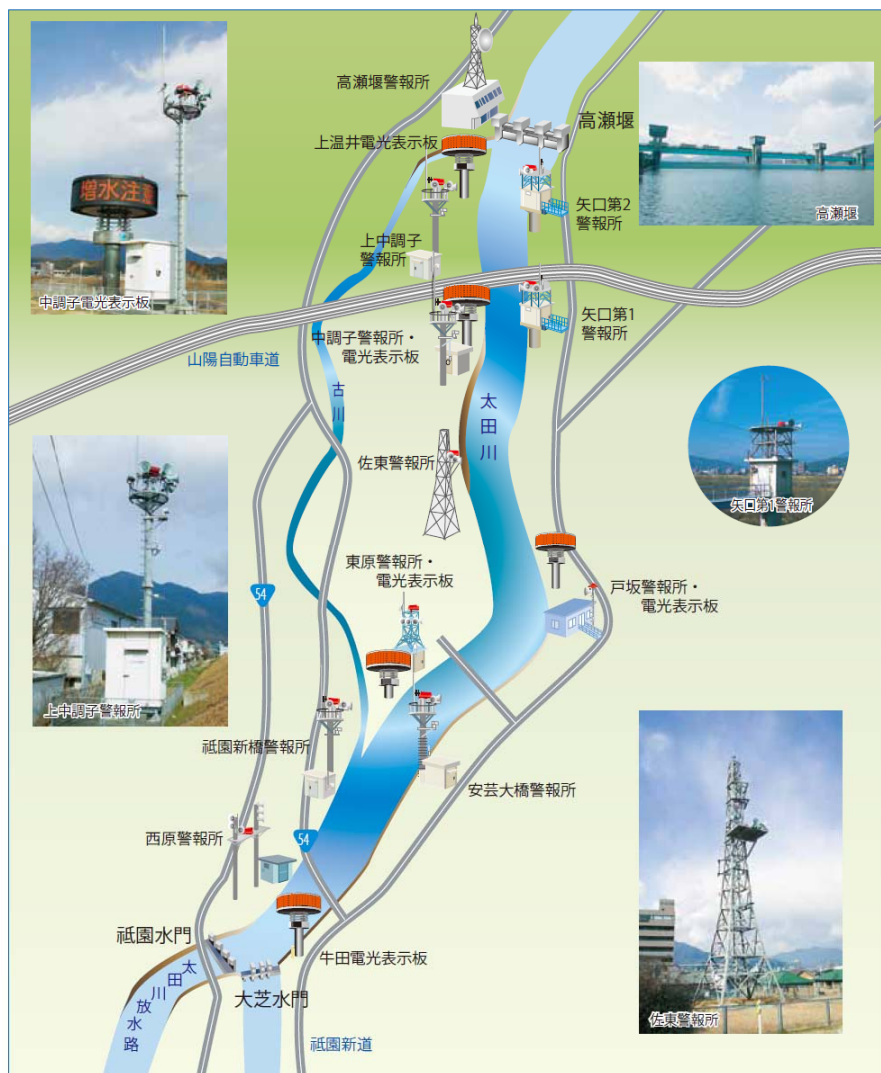
警報施設設置箇所
