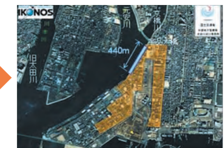
土のうを設置しなかった場合、上記着色範囲約67haが浸水していたと想定されます。
