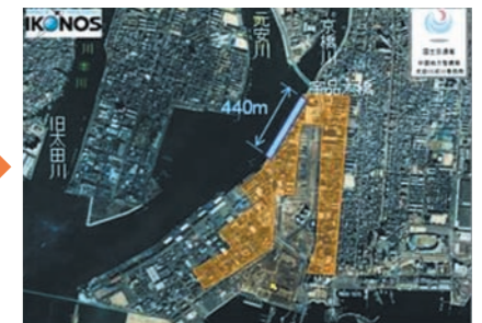
土のうを設置しなかった場合、上記着色範囲約67haが浸水していたと想定されます。
