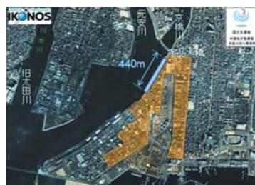
土のうを設置しなかった場合、上記着色範囲約67haが浸水していたと想定されます。
