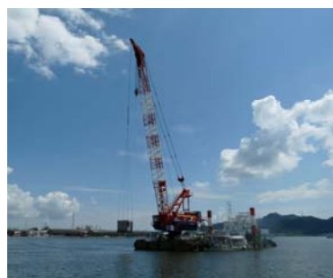
作業船による沈降障害物の揚収作業
