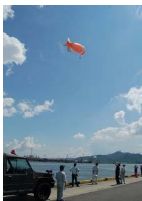
気球空撮システムによる港湾の被災状況調査
