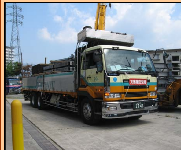
▲ 応急組立橋梁 積込・輸送 (中国技術事務所)
