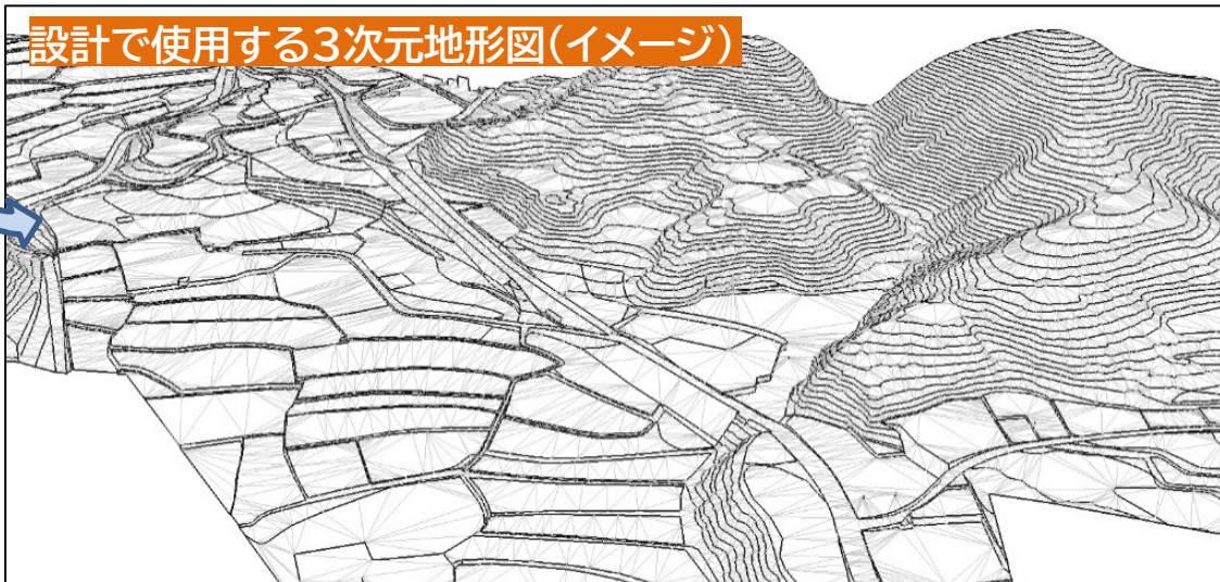
ドローンを使って 高さ情報などを取得し地形図を作成
