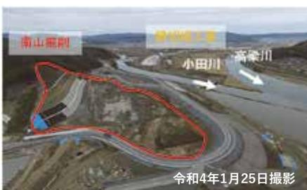
南山掘削工事は、山頂（標高67m）から約5.5m掘削（将来の道路の高さより少し下まで）完了しました。引き続き掘削を進めるとともに、掘削した法面を安定させるために鉄筋挿入工を施工しています。また新合流点付近では橋梁上部工の施工が進んでいます
