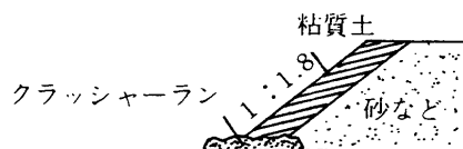
図2-4-2 盛土のり面の被覆
