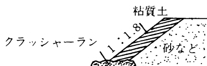
図2-4-2 盛土のり面の被覆
