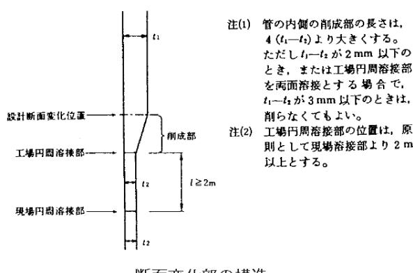
断面変化部の構造
