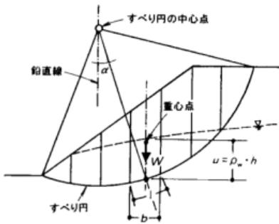
図 2.2 すべり破壊に対する安定計算
