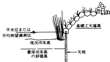
図 1－4－10 基礎工天端高と根固めの組み合わせ
