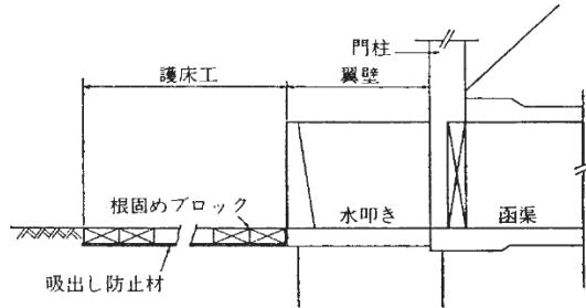
図2-4-18 護床工（根固めブロックの例）
