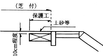
図1-4-16 法肩工の保護工例
