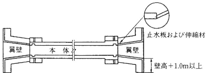
図2-4-8 翼壁平面図
