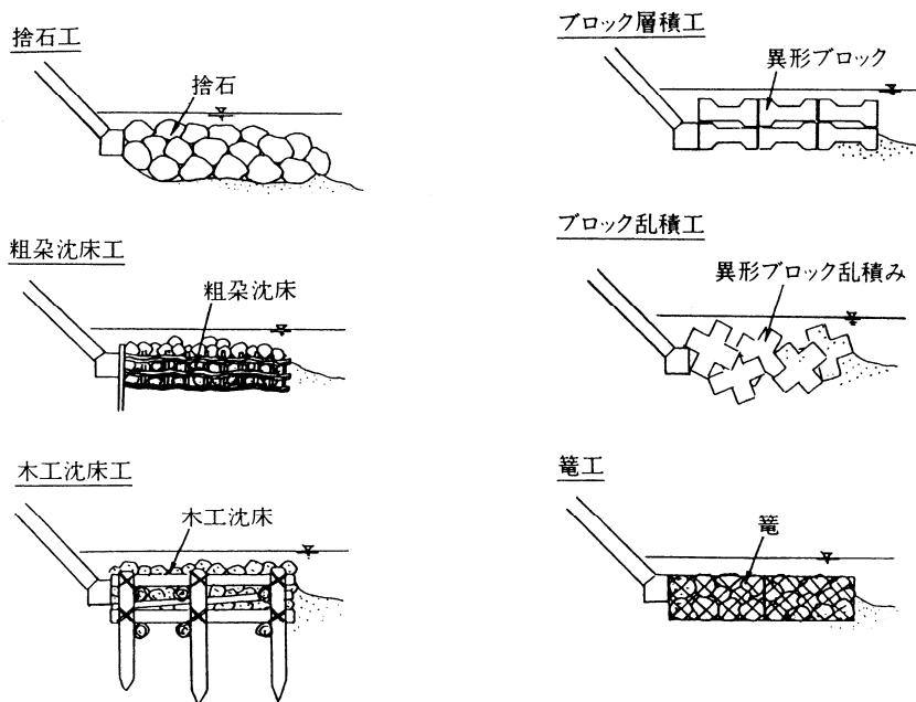
図 1-4-13 根固工の代表的な工種
