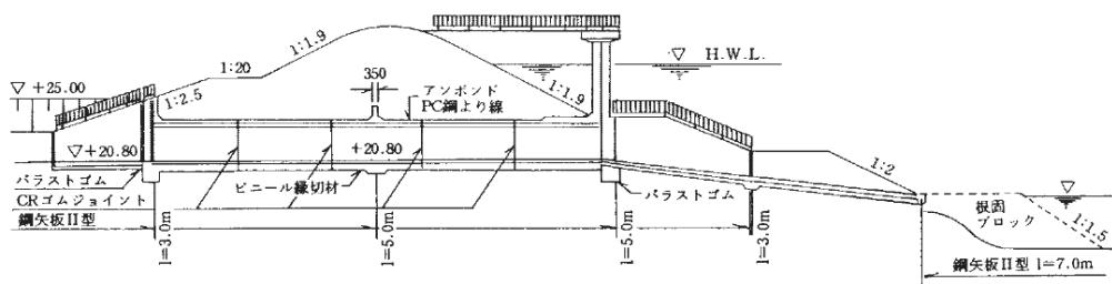
図2-3-2 軟弱地盤上の柔構造樋門の事例
