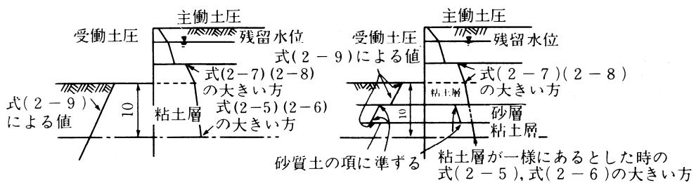
図 1-4-21 地震時の粘性土の土圧
