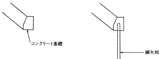
図 1－4－12 基礎工およびのり留工の例
