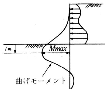
図 1-4-24 自立式鋼矢板壁の曲げモーメント
