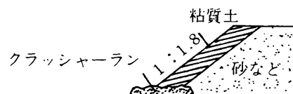
図2-4-2 盛土のり面の被覆
