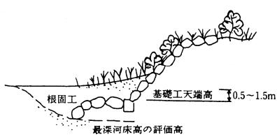
\*根固工の設置位置は、基礎工天端高よりも上として、洗掘を防止する方法もある。
