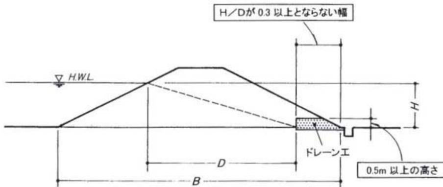
図2.7 ドレン工の断面と平均動水勾配
