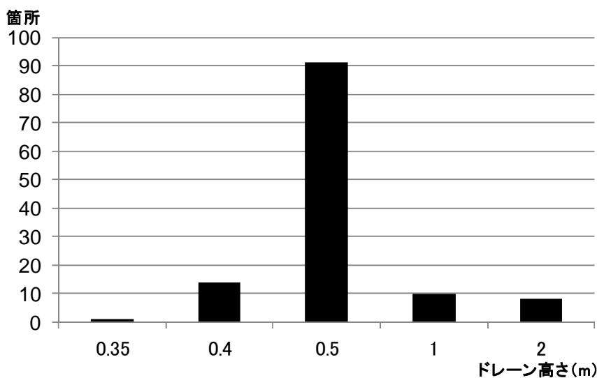
図2.10 ドレン工の高さ(厚み)の現地事例
