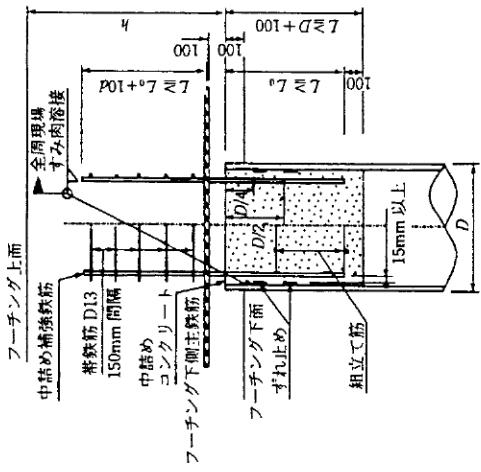
図 4-1-3 鋼管ソイルセメント杭方法A
