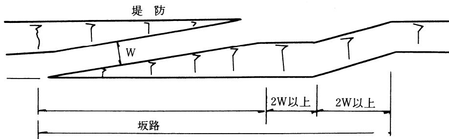
図 1-2-13 坡路の平面形（堤防に平行）
