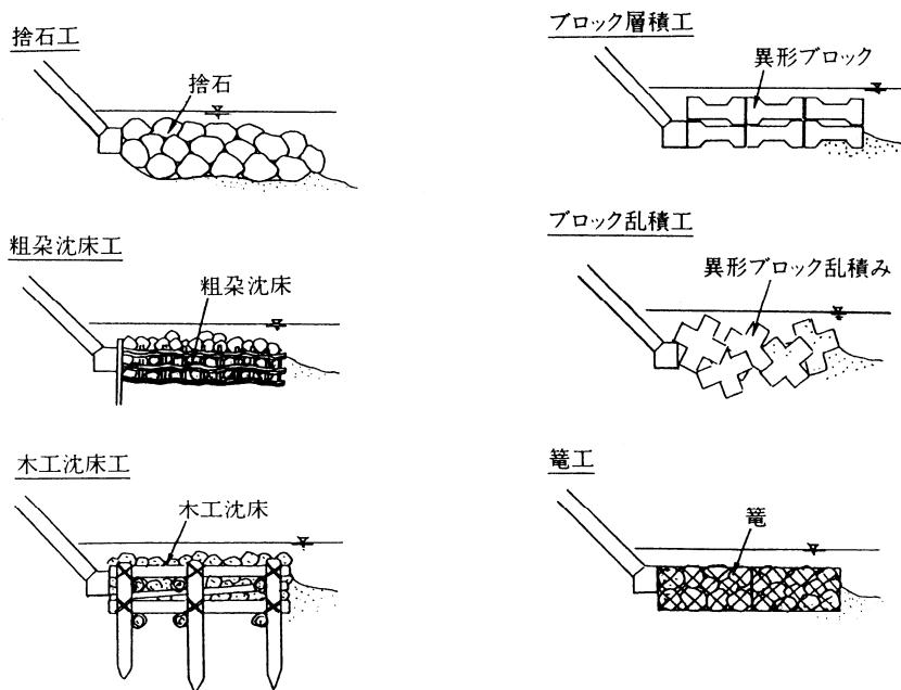
図 1-4-12 根固工の代表的な工種
