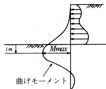
図1-4-22 自立式鋼矢板壁の曲げモーメント
