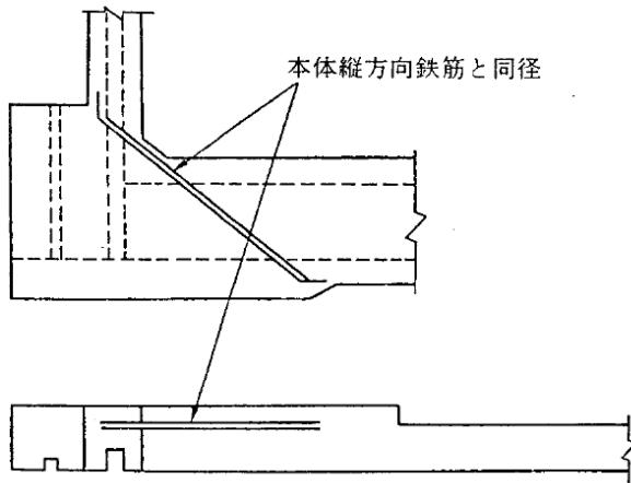
図2-5-2 門柱と函渠接続部の配筋
