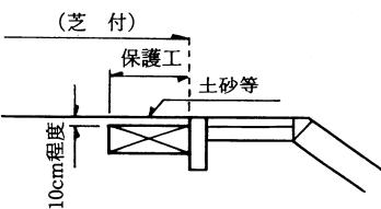
図1-4-14 法肩工の保護工例
