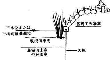
図 1－4－10 基礎工天端高と根固めの組み合わせ
