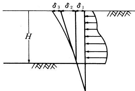
図 1-4-24 自立式鋼矢板壁のたわみ
