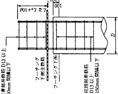
図 4-1-6 鋼管ソイルセメント杭方法B
