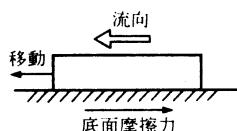
② めくれ：流体力の作用によって部材がめくれる現象である。小口のないのり覆工端部等に生ずる。例えば、すりつけ護岸の連節ブロック端部の破壊現象にみられる。
