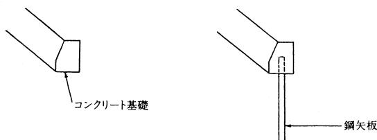
図 1－4－11 基礎工およびのり留工の例
