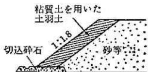
図2-3-5 盛土のり面の被覆
