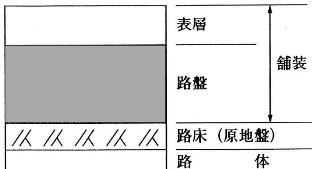
図3-2-1 舗装の基本的な構成
