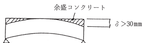
図5-5-2 余盛りコンクリート
