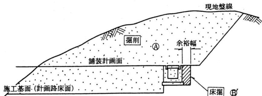
注) 1. 掘削Aの領域は、施工基面（計画路床高）より上の部分で、構造物を施工する為に掘削される部分Bは含まない。
