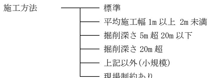
注) 1. 施工方法「上記以外(小規模)」とは、1箇所当たりの施工土量が 100m<sup>3</sup> 程度まで、又は平均施工幅 1m 未満の床掘りで、「1箇所当たり」とは、目的物 1箇所当たりであり、目的物が連続している場合は、連続している区間を 1箇所とする。
