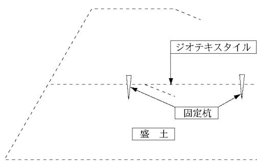
図E 巻込み工法(壁面材なし)参考図
