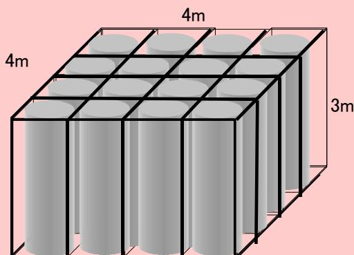
対象土量  $V = 4\text{m} \times 4\text{m} \times 3\text{m} = 48\text{m}^3$
