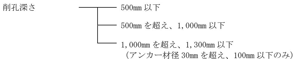
(4) コンクリート削孔（さく岩機〔ハンドドリル〕）の削孔深さによる区分は、以下のとおりとする。
