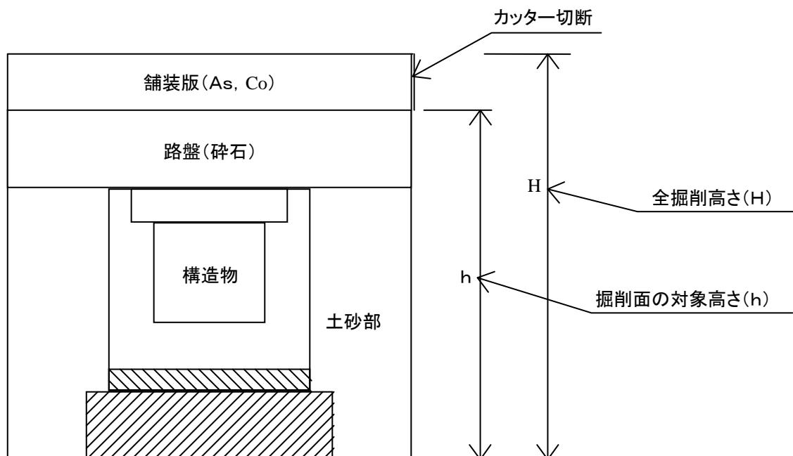
注) 掘削面の高さの取扱い
