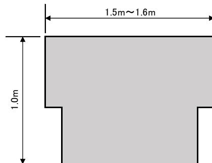
アンカ一補強土壁正面図
