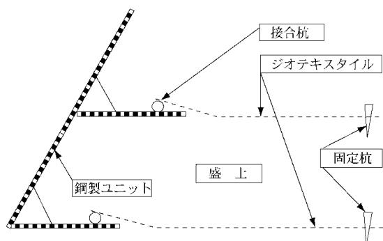
図A 鋼製ユニット工法参考図
