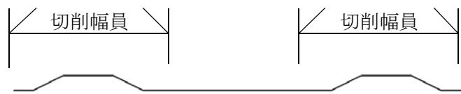
2) 1施工箇所において、全面切削と帶状切削が混在する場合は、全面、帯状ごとに数量を算出する。
