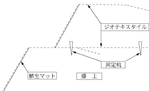
図C 巻込み工法(植生マット)参考図
