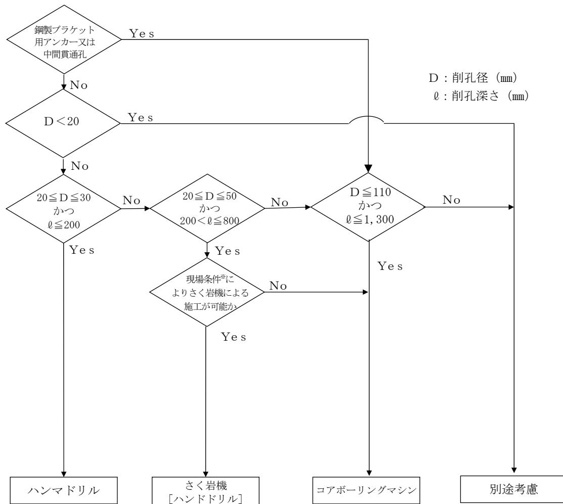
※現場条件とは、作業スペース、騒音・振動による制限及び既設配筋間隔等による施工障害とする。
