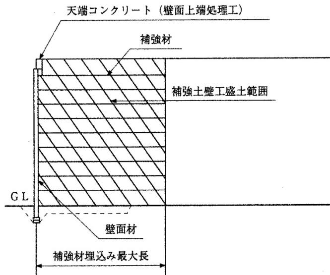
補強土壁工標準断面図
