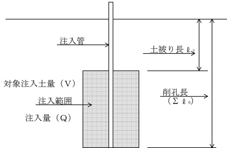
施工図 (二重管ダブルパッカー工法)
