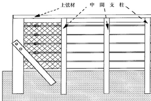
○落石防護柵 柵高の考え方
