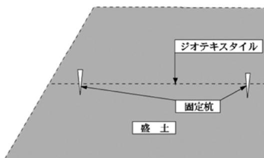
図C 普通敷設工法（壁面材なし）参考図
