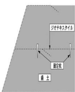
図B 卷込み工法（壁面材なし）参考図
