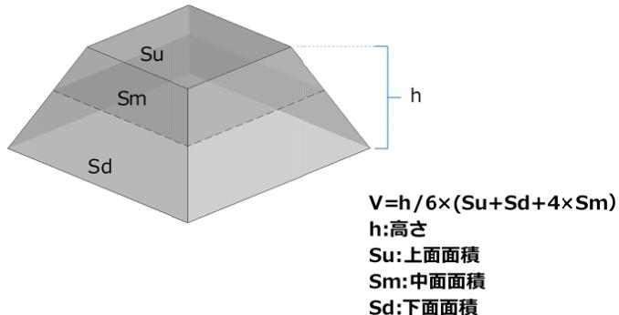
② 単純な幾何図形に分割した各体積を基に各体積の和、差等の集合演算により算出する。
