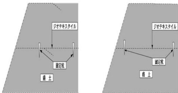
図C 普通敷設工法（壁面材なし）参考図
