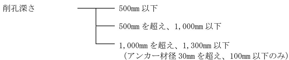
(4) コンクリート削孔（さく岩機〔ハンドドリル〕（空圧式））の削孔深さによる区分は、以下のとおりとする。
