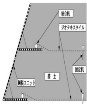
図A 鋼製ユニット工法参考図
