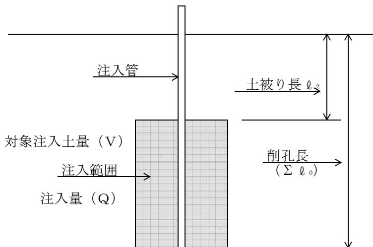
施工図（二重管ダブルパッカーア工法）
