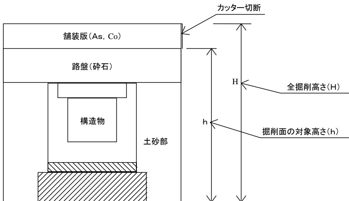
注) 掘削面の高さの取扱い
