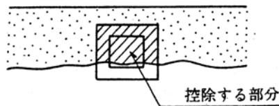
2) 構造物に裏込め材を使用する場合には、盛土量からこれを控除し、別途裏込め材（セレクト材）の数量を算出する。
