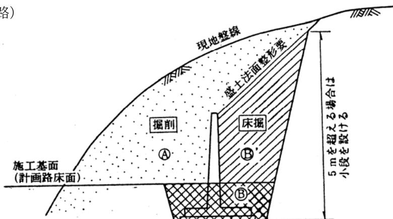
注) 1. B'領域については、実作業は「掘削」行為となるが、数量算出上は、「床掘」として算出するものである。
