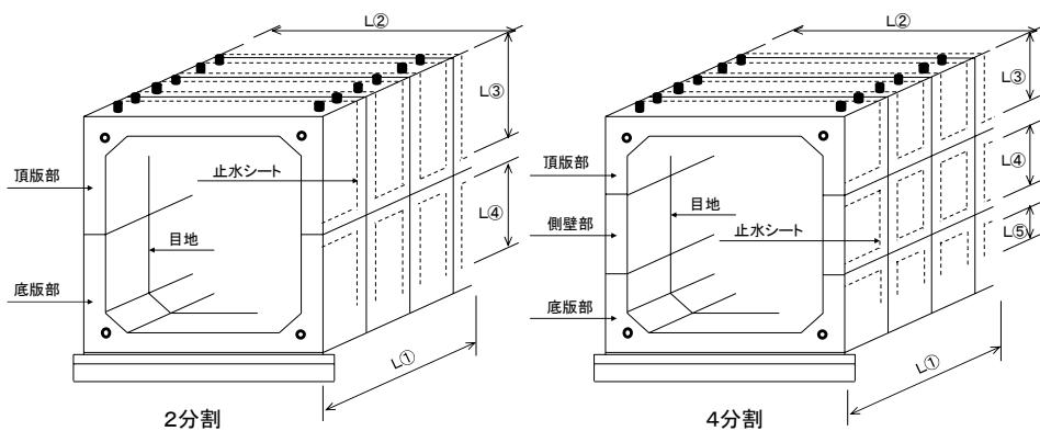
(注) 止水シートは、漏水等が懸念される箇所に設置した延べ延長を計上する。
