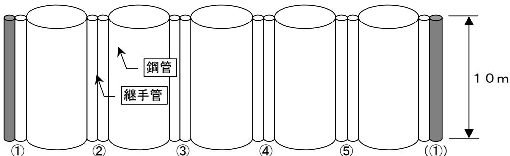
継手管延長 × 継手箇所数
