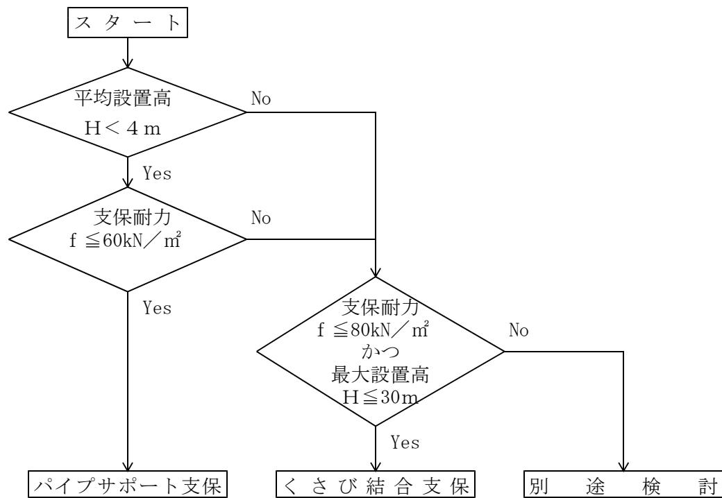
注) 支保耐力  $80 \text{ kN/m}^2$  を超える場合、又は最大設置高さが  $30 \text{ m}$  を超える場合は、別途工法等を検討するものとする。
