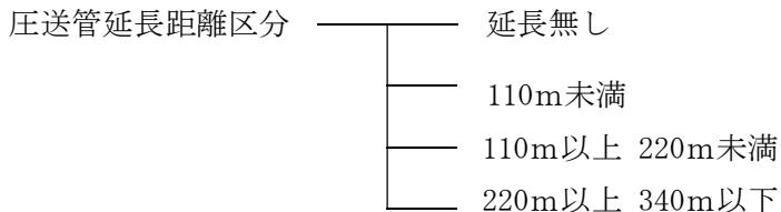
注) 圧送管延長距離区分は、作業範囲（30m）を超えて圧送管を延長する場合に、超えた部分の延長距離を該当する区分から選択する。
