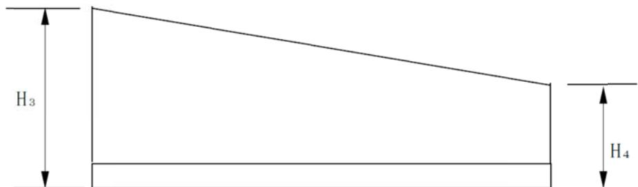
$$\text{平均設置高さ} = 1/2 \times (H_3 + H_4)$$
