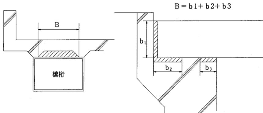
$$A = B \times L \quad A : \text{型枠面積 } (m^2)$$
