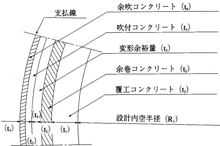
設計掘削半径 = 設計内空半径 ( $R_1$ ) + 覆工コンクリート厚 ( $t_1$ ) + 吹付コンクリート厚 ( $t_3$ )
