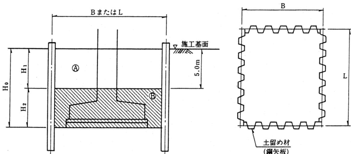
注) 1. 土留工の規模等により、A領域で同一機種による床掘りが不適当な場合は、別途その部分の断面積を区分できるものとする。
