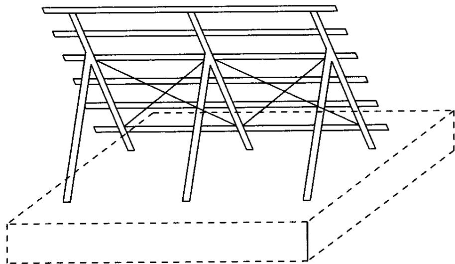
2) 吊柵 — 固定アンカーを有しワイヤ等で柵を吊っているもの
