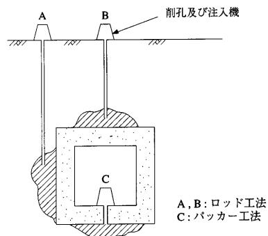
2. 削孔径はロッド工法がφ46mm、パッカーワークがφ52mm（2インチ）を標準とする。
