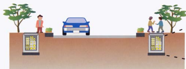
電線共同溝 (C・C・BOX) のイメージ図
