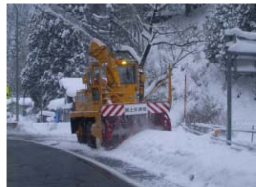
ロータリ除雪車 ※路肩に溜まった雪を 取り除く機械
